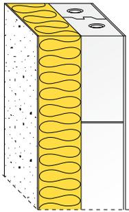
Wärmedämmverbundsysteme werden seit 1950 gebaut. Sie sind als funktionsgetrennte Bauweise daher durch langjährige Erprobung sehr ausgereift. Auf den Punkt gebracht handelt es sich bei WDVS mit Kalksandstein um eine tragende Innenschale aus KS, meist in 17,5 cm Dicke, eine Dämmschicht, die sich flexibel an das Anforderungsniveau anpassen lässt, und einen Witterungsschutz aus Außenputz, der für starke Schlagregenbeanspruchung geeignet ist (Beanspruchungsgrup-
