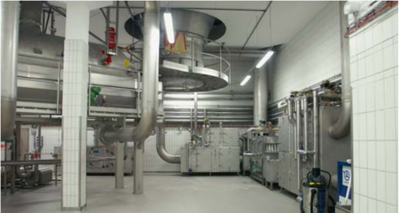
Das Produkt wird als Flüssigkeit eingesprüht und fällt als trockenes Pulver zum Austrag des Zylinders.
