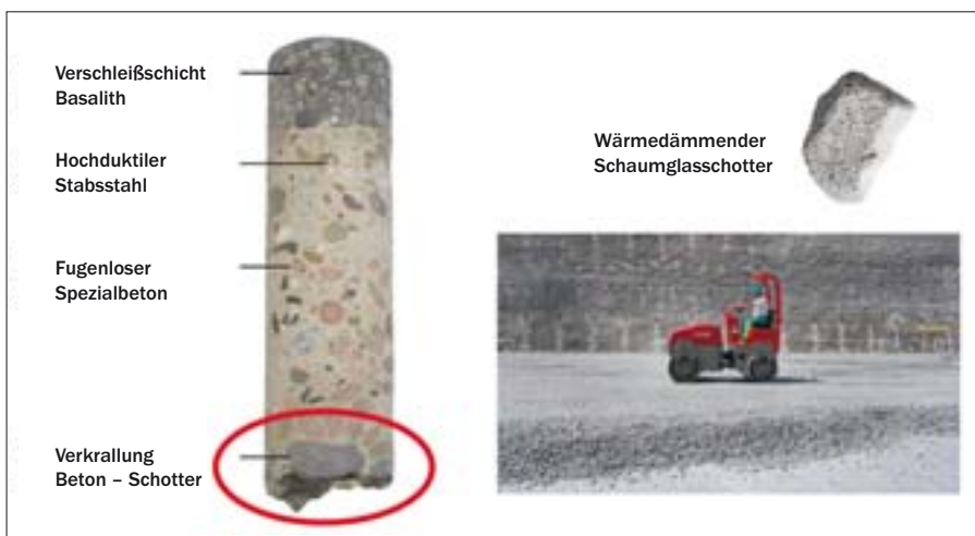
Bild 6: Fugenlose und gedämmte Bodenplatte
