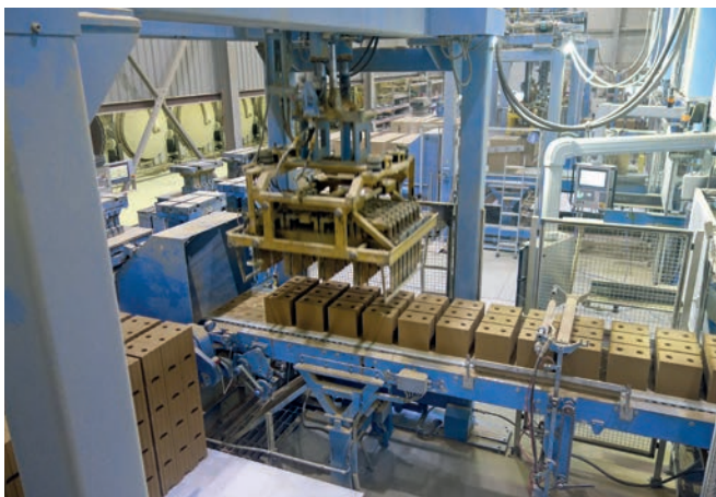
Bild 4 Nach dem Mischen werden die Rohlinge gepresst
