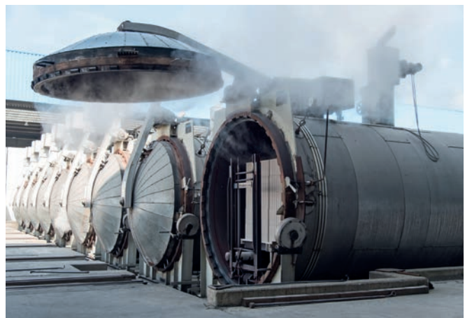
Bild 5 Das Härten der Rohlinge erfolgt in Dampf-Härtekesseln
