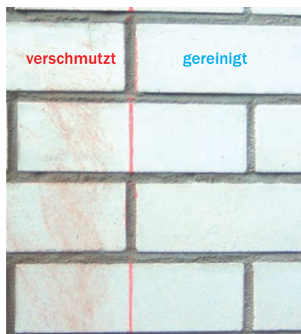
Bild 10 Reinigungseffekt, Beispiel Reinigung mit Schleifpapier, Körnung 140
