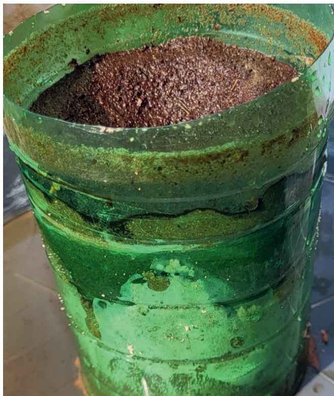
Bild 20 Stauwasser bildet sich aus nach unten sickerndem Wasser, das sich auf einer gering durchlässigen Schicht staut. Zur Verdeutlichung wurde hier in den mit Sand gefüllten Behälter eine durchflusshemmende Schicht eingesetzt, über der Stauwasser zu erkennen ist. Unterhalb ist aber der Sand trocken. Dieses Beispiel verdeutlicht die evtl. Folgen von Inhomogenitäten in Arbeitsraumverfüllungen: Über Staulinsen kann sich Stauwasser bilden, das wegen der Staulinsen aber nicht unter diesen ist.
