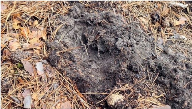
Bild 17 Nach ca. 5 h Landregen und 1 h Starkregen sickerte in diesem Beispielfall mit Feinsand und Schluffanteilen Oberflächenwasser nur langsam in eine geringe Tiefe in den Boden von etwa 5 cm
